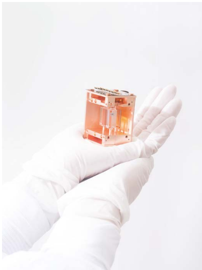
c. Uno dei moduli criogenici dell'esperimento CRESST durante la fase di assemblaggio del rivelatore.
