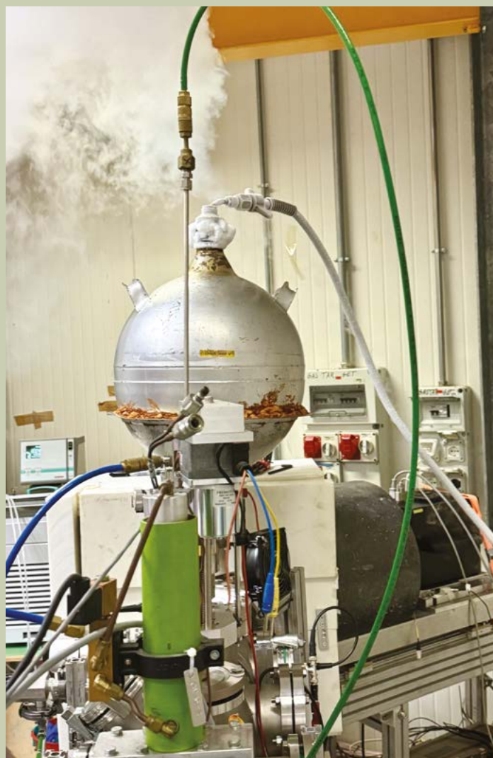
a. Dettaglio dell'apparato sperimentale di LUNA400 ai Laboratori del Gran Sasso. In primo piano si vedono la linea di fascio, che trasporta le particelle accelerate fino al bersaglio, e parte del sistema di rivelazione usato per misurare le reazioni nucleari di interesse astrofisico.
