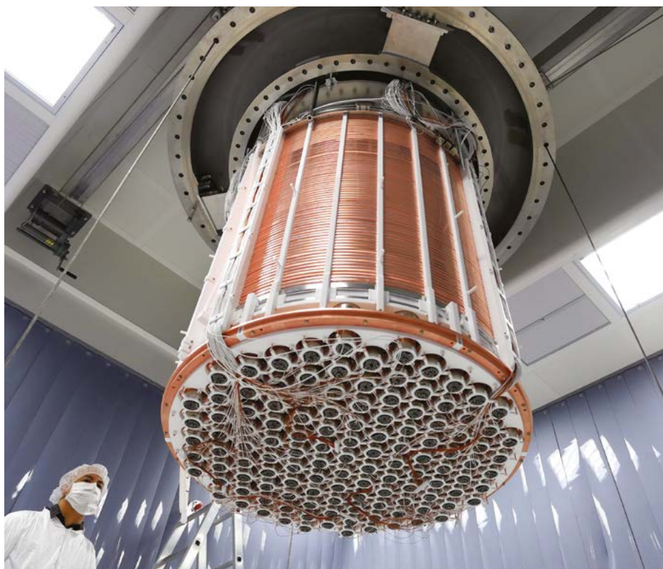
b. Dettagli della Time Projection Chamber dell'esperimento XENON-nT durante le fasi di costruzione dell'apparato.
