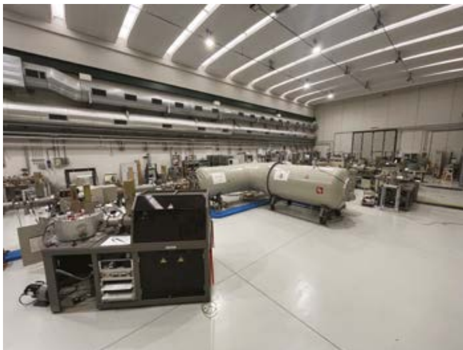
c. Sala sperimentale del LABEC (Laboratorio di Tecniche Nucleari per l'Ambiente e i Beni Culturali di INFN Firenze e UniFI), dove è installato un acceleratore elettrostatico da 3MeV con il quale vengono effettuate misure di spettrometria di massa con acceleratore (AMS) per la misura della concentrazione di carbonio-14.
