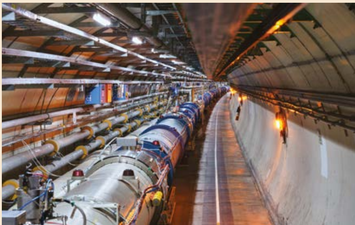
a. Il Large Hadron Collider (LHC), il più grande e potente acceleratore di particelle al mondo, situato al CERN vicino a Ginevra. LHC fa collidere protoni (e nuclei pesanti) circolanti in due anelli di 27 km a energie fino a 14 TeV, ricreando condizioni simili a quelle dell'universo primordiale, per studiare le particelle fondamentali e le leggi della fisica. Grazie a questa straordinaria macchina si è scoperto il bosone di Higgs.
