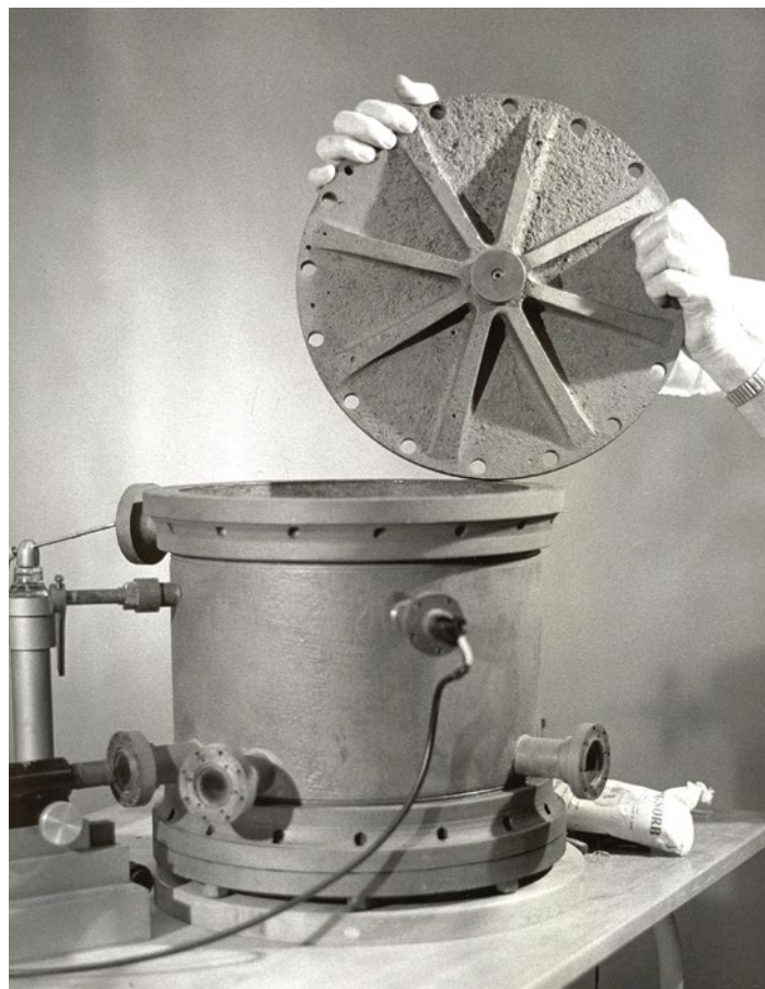
b. L'apparato con cui Millikan e Fletcher misurarono la carica dell'elettrone nel 1909.
