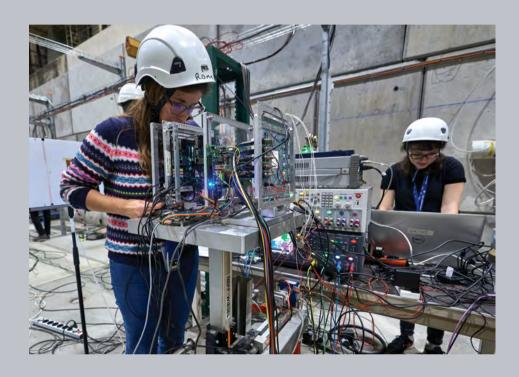
Foto relativa a una delle fasi della campagna di test condotta nel 2018 al Cern su Myriad 2 (Intel), chip di intelligenza artificiale dedicato all'integrazione grafica, per conto dell'Agenzia Spaziale Europea (Esa). II funzionamento dell'unità di processazione video viene verificato a seguito della sua esposizione a radiazione per comprenderne il possibile utilizzo in ambito spaziale.
