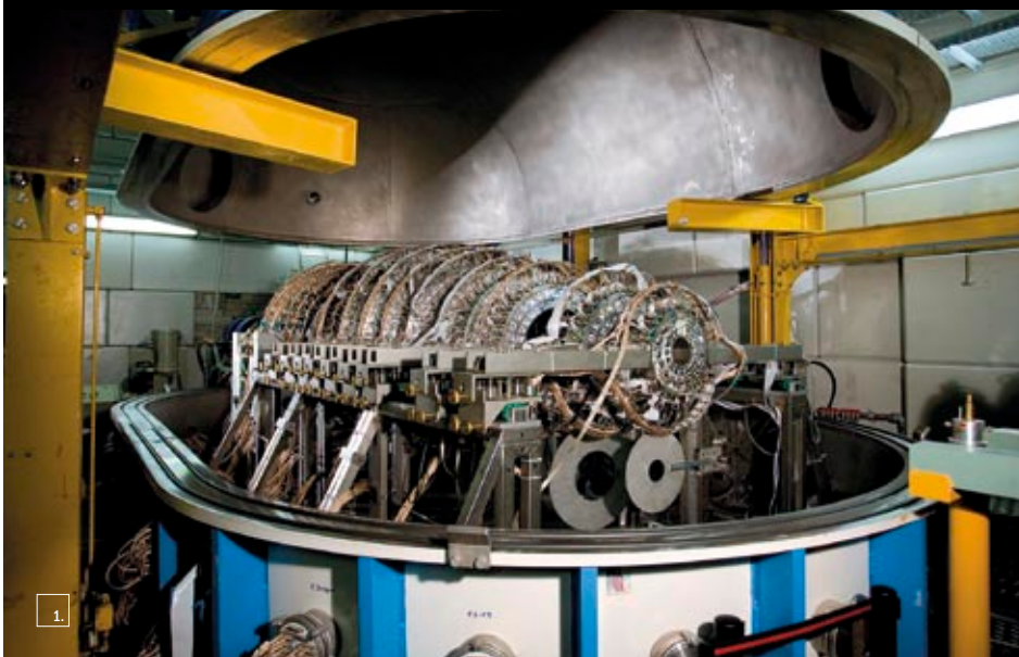
1. Il rivelatore Chimera installato ai Laboratori Nazionali del Sud dell'Istituto Nazionale di Fisica Nucleare. L'apparato è costituito da circa 1200 moduli di rivelazione distribuiti su 9 ruote concentriche, alcune ben visibili nella foto e una sfera, al centro della quale avviene la collisione nucleare. Le dimensioni del rivelatore sono di circa 4 metri di lunghezza e 2 metri di altezza.
