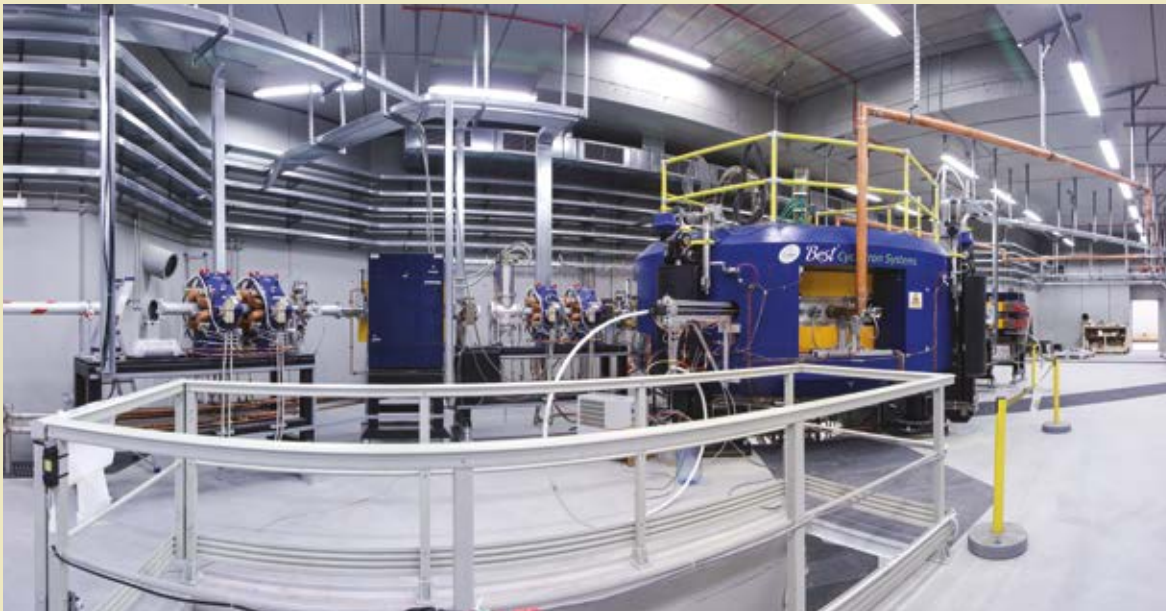
a. Il ciclotrone SPES, un acceleratore circolare di protoni, operativo presso i Laboratori Nazionali di Legnaro dell'INFN per esperimenti di fisica nucleare e per la produzione di radiofarmaci.
