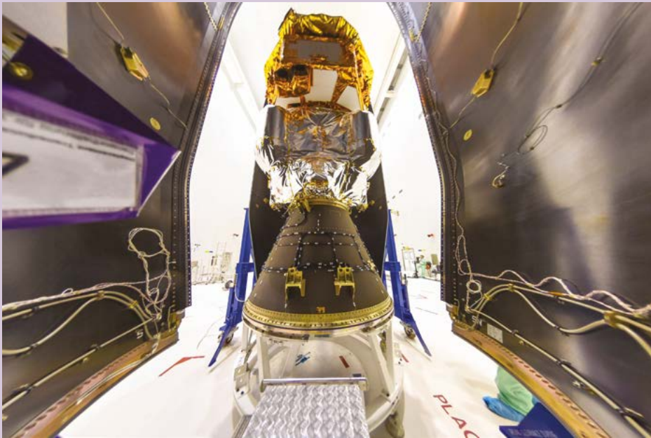
a. Il satellite di LISA Pathfinder completo del suo modulo di propulsione, mentre sta per essere incapsulato nel razzo VEGA (Vettore Europeo di Generazione Avanzata) presso lo spazioporto di Kourou, nella Guyana francese.
