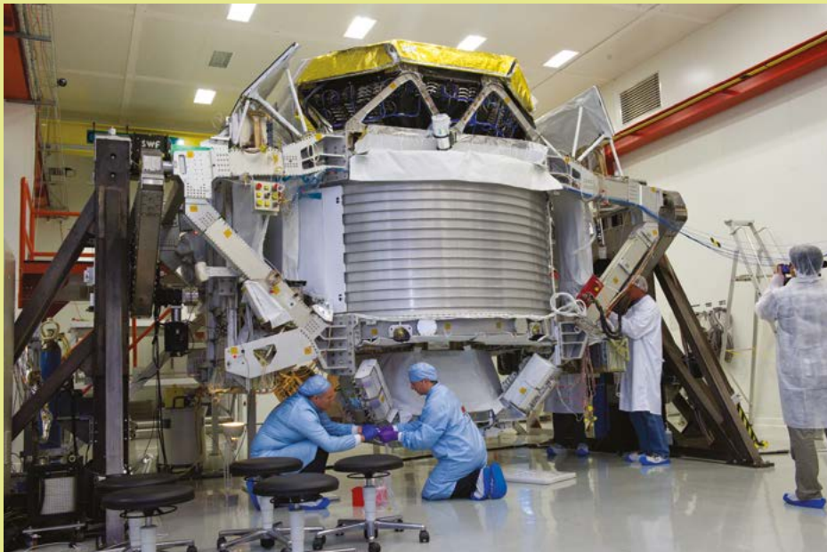
a. L'apparato AMS-02, nella Clean Room, al CERN, in cui è stato assemblato. Nella foto solo una parte del MultiLayer Insulator (MLI, il tipico materiale bianco che riflette la radiazione solare con cui vengono rivestite le apparecchiature nello spazio) è installata, lasciando "nude" le strutture e i rivelatori sottostanti.
