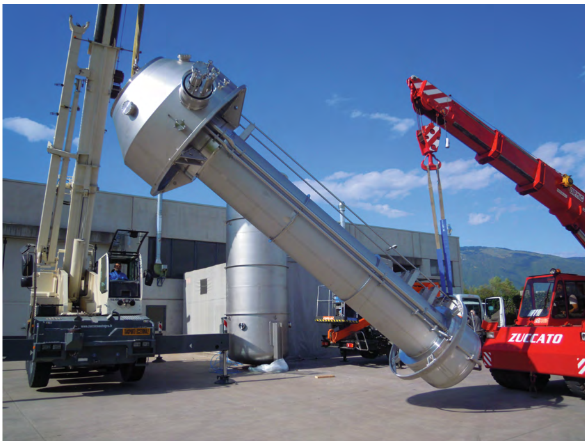
b. Criostato per il test di magneti superconduttori al Cern, prodotto da Alca Technology a Schio (VI).
