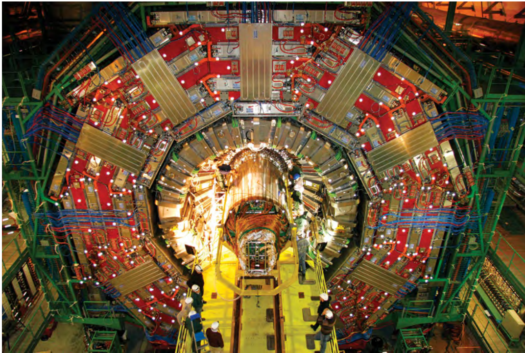
C. Vista dell'esperimento Cms senza i rivelatori "endcap" che coprono le due basi del cilindro che costituisce il rivelatore, disposto attorno alle camere da vuoto lungo cui corrono i fasci di protoni: dall'esterno verso l'interno sono visibili i grandi rivelatori per muoni, inframezzati al ferro del ritorno del campo magnetico (settori rossi più esterni), il criostato del magnete superconduttore, all'interno del quale si trovano i calorimetri (adronico ed elettromagnetico), e i tracciatori al silicio (cilindro più sporgente interno).
