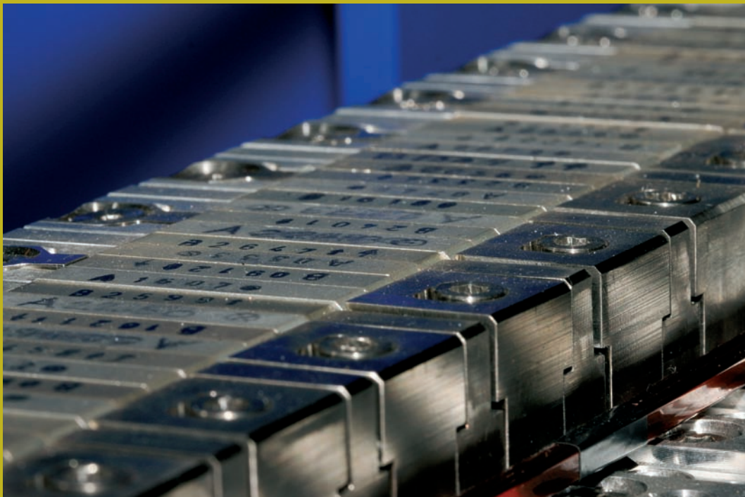
a. Espansioni polari dell'ondulatore magnetico di Sparc nei Laboratori Nazionali di Frascati dell'Infn (vd.p. 30): il periodo dell'ondulatore (cioè la distanza tra due poli nord successivi, individuabile come la distanza tra due viti contigue) è pari a 2,8 cm.
