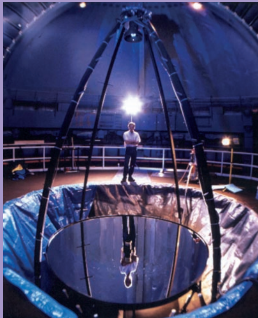
a. Telescopio a specchio liquido della Nasa. Si trovava nell'Orbital Debris Observatory a Cloudcroft (New Mexico, Stati Uniti) ed è stato chiuso nel 2001.
